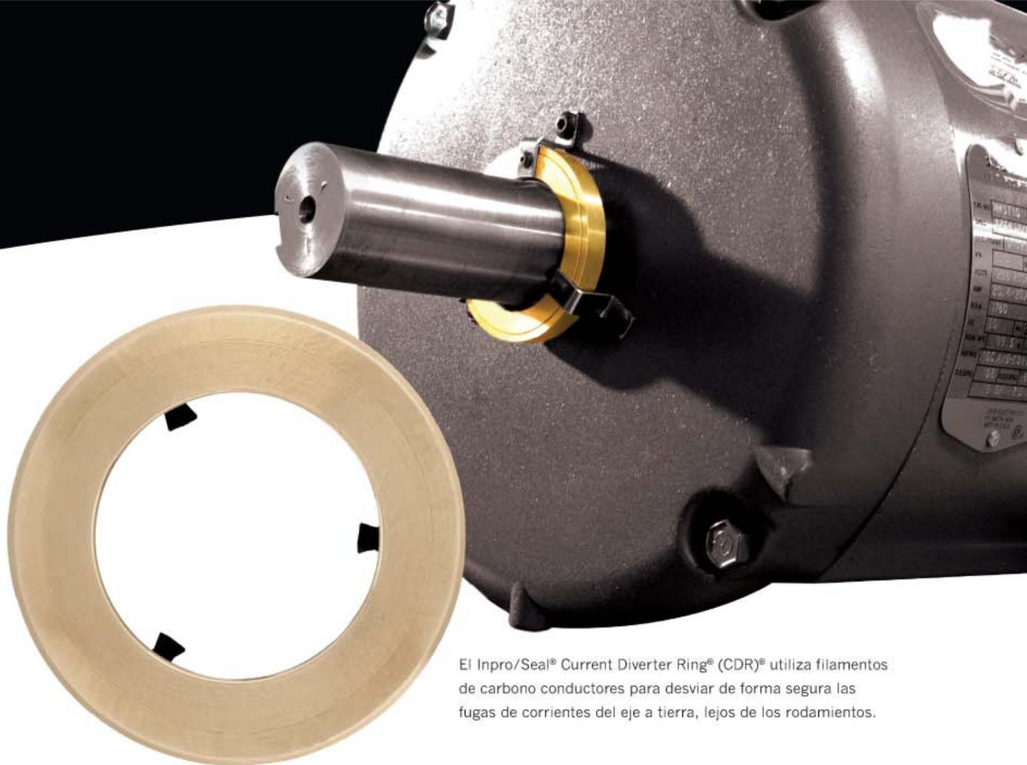
El Inpro/Seal® Current Diverter Ring® (CDR)® utiliza filamentos de carbono conductores para desviar de forma segura las fugas de corrientes del eje a tierra, lejos de los rodamientos.
